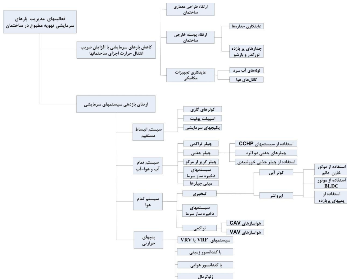
شکل ۱-۱: درخت فناوری مدیریت بارهای سرمایشی تهویه مطبوع
